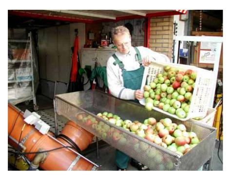
Der Stapel wird kistenweise so weit gehoben, dass die Kiste nur noch seitlich ausgeschüttet werden braucht. Danach wird das Obst von Hand langsam in die Einlauföffnung der Waschmaschine gezogen.
