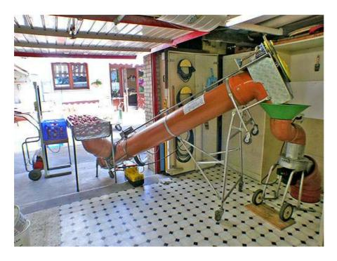
Aufstellung der kompletten Wasch- und Mahlanlage in Erdgeschossebene. Das an der Obstwanne an die Waschmaschine übergebene Obst kommt in einem Durchgang maschinell bearbeitet als Maische im Sammler des darunter liegenden Pressraumes an.
