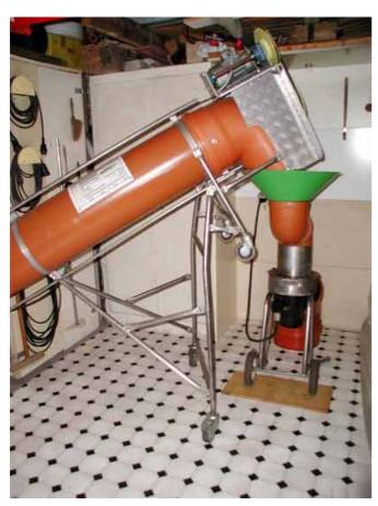
Das hier gereinigte Obst fällt in den Obsthäcksler, wird zur Maische umgewandelt und fällt über den Auswurf des Häckslers in das eingesteckte Maischerohr im Fußboden. Von dort ein Geschoss tiefer in den untergestellten Maischesammler im Pressraum.
