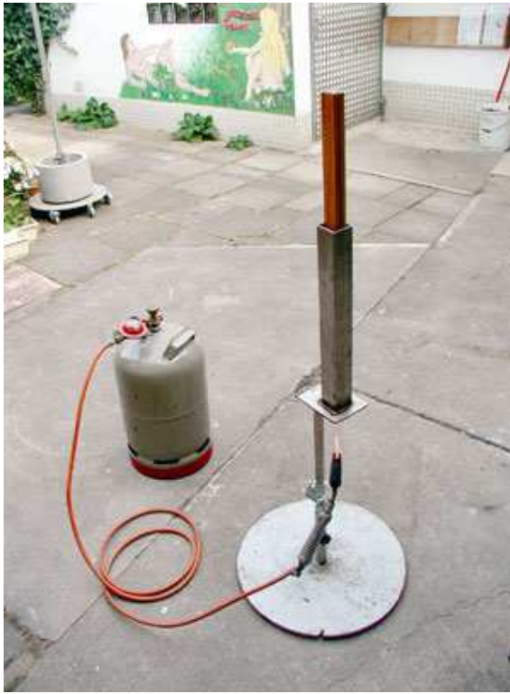
Foto 3: Das Tauchbad besteht aus Rechteckrohr, auf Stahlplatte geschweißt.
