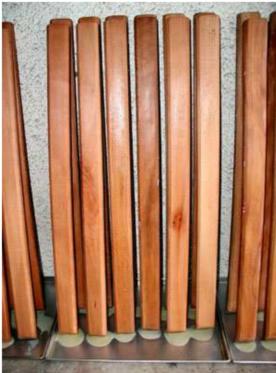
Foto 4: Getränkte Leisten auf dem Abtropfblech.
