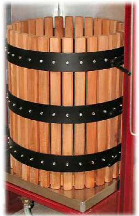
Foto 5: Mit Rindertalg behandelter Buchenholz-Presskorb
