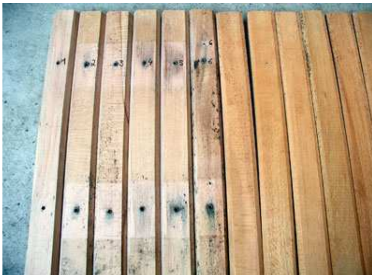
Foto 1: Zerlegter Presskorb aus Buchenholzleisten Links: Aussenseite, rechts: Innenseite (Rohzustand)
